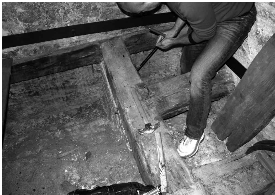
13. Torre di piazza: dettaglio del prelievo per l'analisi dendrocronologia eseguito da CNR – IVALSA nel febbraio 2011
